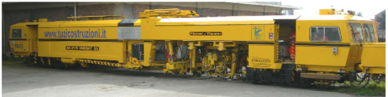
Rincalzatrice ferroviaria Plasser & Theurer 08.275 3S capace di rincalzare, allineare e livellare il binario in corretto tracciato ed in deviata (nel caso di deviatoi) con sofisticati sistemi di controllo elettronici.
