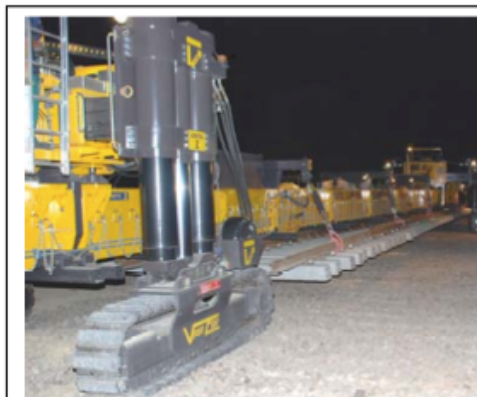
Sistema Vaiacar TLPS 6500 per il varo degli scambi in cap di nuova specifica in unica soluzione e per la costruzione del binario sia a campate che con sistema continuo tipo "treno di rinnovamento".
